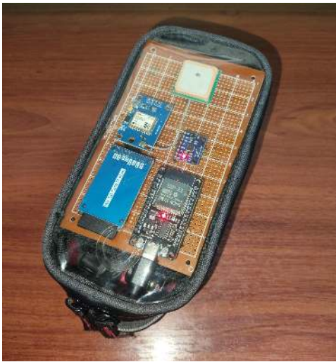
Fig 34. Fotografía del montaje final protegido con la montura ciclista
