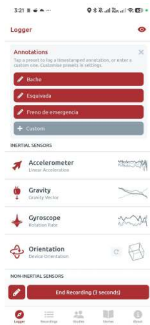
Fig. 3. Screenshot de aplicación Sensor Logger. La interfaz de la aplicación sensor logger permite realizar anotaciones manuales a eventos mientras se obtienen los datos inerciales
