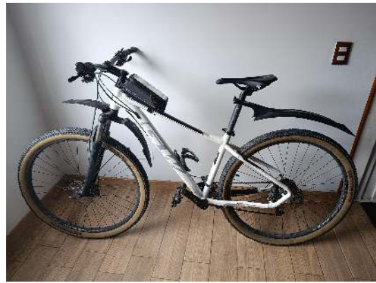
Fig. 1. Configuración del montaje experimental. El smartphone se fijó al cuadro de la bicicleta con una pequeña maleta sujetada con broches en velcro.
